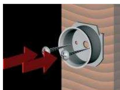
5. Dřevěné trámy s namontovanými základovými víčky položíme na zemní vruty a připevníme pomocí šroubů na zemních vrutech.
